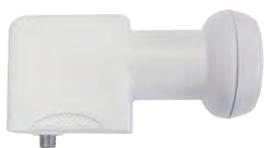
Questo LNB è ideale per la realizzazione di **impianti residenziali monofamiliari** perché dispone di **un'uscita SCD2 (dCSS)** in grado di servire fino a 4 decoder SAT SCR e contemporaneamente offrire le 12 frequenze necessarie al funzionamento del nuovo decoder SKY-Q; il tutto attraverso un solo cavo.
