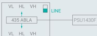
In tutti i modelli della serie non c'è prelievo di alimentazione dalla **linea HH**: questa porta Satellite viene utilizzata per far passare una corrente in modo **diretto**, senza alcun assorbimento da parte dell'amplificatore, ad esempio per alimentare l'LNB utilizzando un alimentatore dedicato alla base dell'impianto.
