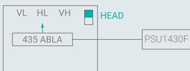
**Alimentazione da linee Satellite passanti VL, HL o VH:** questo è il tipico caso di amplificatore di **linea**, il prodotto viene interamente alimentato dalle linee Satellite e **passa la tensione** verso le porte di ingresso, per alimentare un eventuale LNB, senza alcuna limitazione di corrente per non interferire con l'impianto esistente; in questa configurazione il dip switch deve essere posizionato in **modalità LINE**.
