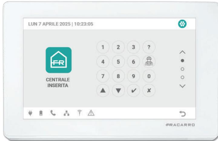
Sviluppata interamente dal **reparto Ricerca e Sviluppo Fracarro**, la tastiera **T8 TOUCH** permette di controllare tutte le funzioni del sistema tramite interfacce intuitive. Oltre alle consuete operazioni di attivazione e disattivazione, l'utente può configurare **tasti rapidi** con funzioni personalizzate, come l'inserimento della partizione notturna o dei sensori perimetrali.
