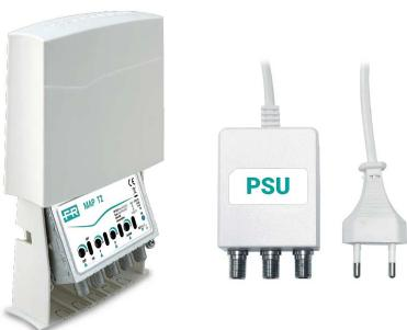
**Amplificateur sur mât à 4 entrées (FM, III+DAB, UHF, SAT)** avec gain de 25dB et niveau de sortie jusqu'à **116dB $\mu$ V dans la bande UHF**, amplification VHF/UHF séparée, réglage indépendant du gain (0-15dB) pour chaque entrée et faible facteur de bruit.
