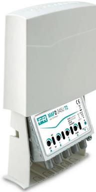
Amplificateur de mât avec 4 entrées (III+DAB, IV, V, UHF) avec un gain de 25dB et niveau de sortie jusqu'à 116dB $\mu$ V en bande UHF, amplifications séparées VHF/UHF, réglage du gain (0-15 dB) indépendant pour chaque entrée et faible facteur de bruit. Technologie T2 avec filtre 694 MHz 5G intégré.
