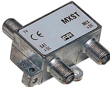
Coupleurs de bande TV et bande SAT pour intérieur ; ils peuvent être utilisés comme découiseurs TV-SAT en se branchant sur l'entrée MIX. Deux versions : standard et à haute isolation entre les entrées.
