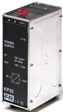
Realizzati con tecnologia switching per assicurare alto rendimento e affidabilità, protetti da sovraccarichi sia temporanei che prolungati. Classe d'isolamento: II. Temperatura di funzionamento da -10°C a +55°C.
