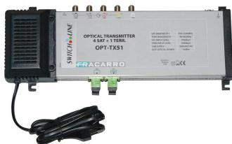
Il trasmettitore **OPT-TX51** converte e distribuisce le 4 polarità satellitari e il segnale digitale terrestre con un solo cavo in fibra, **consentendo risparmio di costi e tempi di installazione**. Il trasmettitore è dotato di **un ingresso ottico aggiuntivo** che può essere utilizzato per la trasmissione di un canale ausiliario in un range ottico compreso tra 1260nm - 1500nm.
