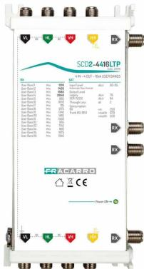
Multiswitch **SCD2 en cascade (dCSS)**, 4 entrées avec CAG et 4 sorties dérivées avec 16 fréquences chacune et **autodétection du mode de fonctionnement**, alimenté entièrement par le décodeur ou la ligne VL. Fréquences SKY Italia.
