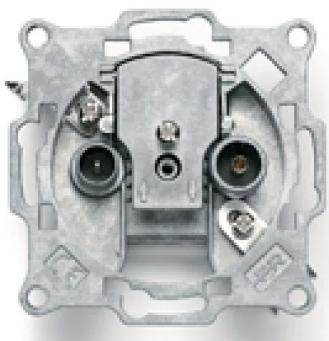
Prise terminale ronde ; 2 sorties femelles IEC femelle pour la bande TV (5-40MHz, 47-862MHz) et IEC mâle pour la bande Satellite (950-2300MHz).
