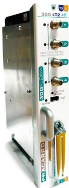
**Transmodulateur DVB-T2/T DVB-C vers DVB-T/C.** Le module vous permet de recevoir à partir de 4 fréquences DVB-T ou DVB-C indépendantes et du panneau arrière ("Smart & Pool") les programmes HD ou SD souhaités, de les décrypter via les CAM professionnels et de les remoduler dans les 4 multiplex numériques disponibles (COFDM ou QAM) dans l'ensemble de la bande de télévision.
