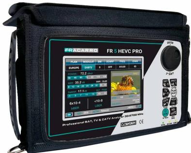
Misuratore di campo combinato Satellite DVB-S/S2 fino a 2610MHz, TV DVB-T/T2 con **compressione H265 HEVC Main 10** e CATV DVB-C Touch Screen capacitivo da 5". Completo di DiSEqC, con protocolli SCR e DCSS (SCD2) e wideband . Compressione video MPEG 2 con qualità d'immagine Full HD o SD. **Misuratore ottico completo di adattatori.** Il corpo in metallo conferisce al misuratore un robustezza adatta all'uso installativo.
