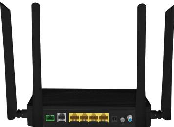
Il ricevitore ottico **ONTG-4G1FTW-H** consente la distribuzione dei dati (internet) attraverso l'infrastruttura in fibra ottica (Passive Optical Network). E' dotato di una porta FXS (POTS) per poter collegare dispositivi telefonici analogici, 4 porte GE e un'uscita CATV RF.
