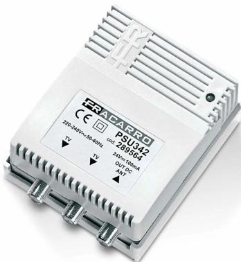
Alimentatore di tipo switching stabilizzato 24V ad alta efficienza e basso consumo con 1 ingresso, 2 uscite e corrente erogata 100mA. Spina di tipo C di connessione alla rete elettrica.
