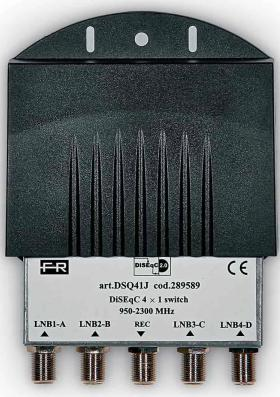
Switch di linea con 4 ingressi controllato dai ricevitori satellitare attraverso i comandi DiSEqC sulla porta di uscita attraverso il cavo coassiale.
