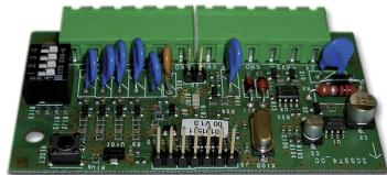
Schede di espansione a 4 ingressi M4IBUS che permette di aumentare il numero di zone delle centrali filari del sistema Defender. Grazie alla connessione a BUS RS485 è possibile remotizzare questi moduli all'interno dell'impianto o per creare dei punti concentratori senza avere la necessità di portare tutte le zone in centrale
