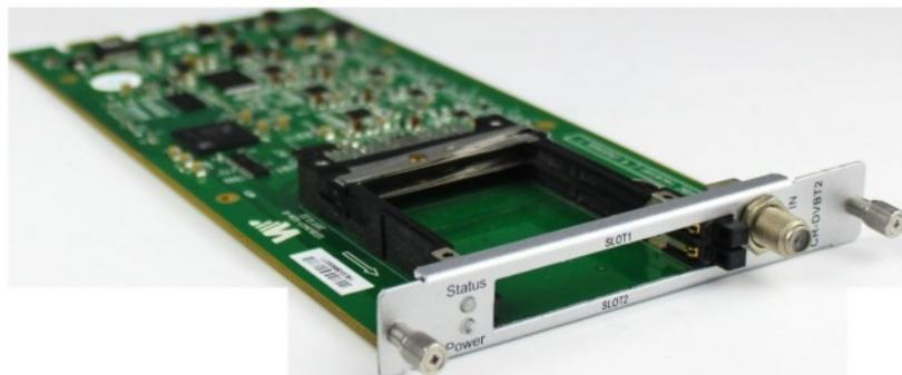
La configurazione del modulo è molto simile a GX-4C2CI-BP-00 (modulo ricevitore DVB-C).
